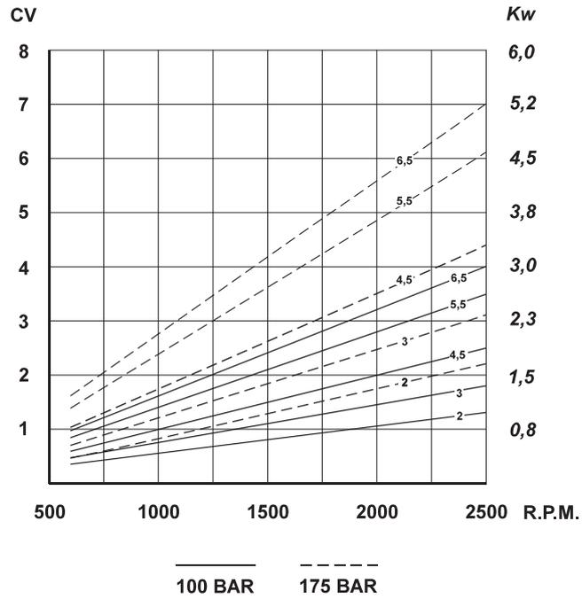
**SINGLE VANE PUMP TYPE BHP-2**
