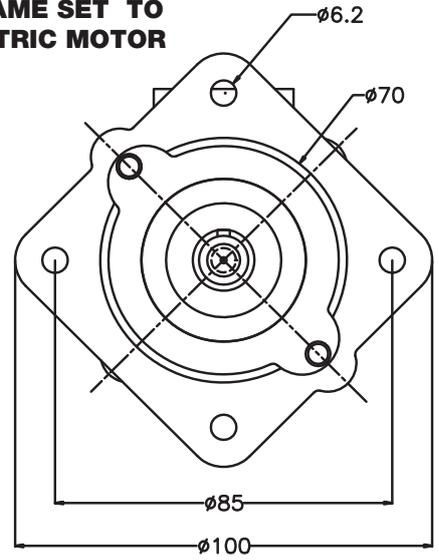
**SINGLE VANE PUMP TYPE BHP-1**
